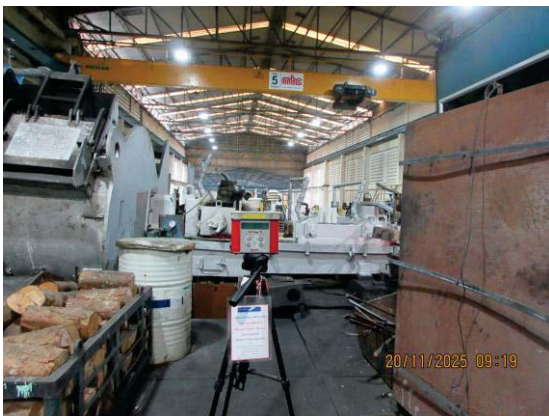
รูปที่ 4-49 แสดงการตรวจวัดระดับความร้อนในการทำงาน รางส่งน้ำทองแดง 2 (คุณครรชิต แก้วชม) ตรวจวัดในวันที่ 20 พฤศจิกายน 2568
